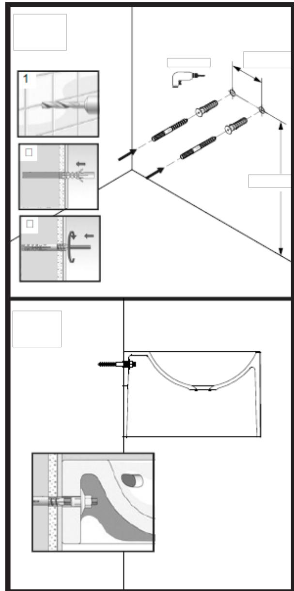
Primeramente, trace los puntos de taladro, según el esquema y cotas del dibujo, para la instalación a la altura recomendada. Realice los dos taladros e introduzca sus correspondientes tornillo y taca en cada uno de ellos.
